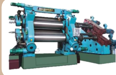
Уплотнение бумаги, придание гладкости и глянца
