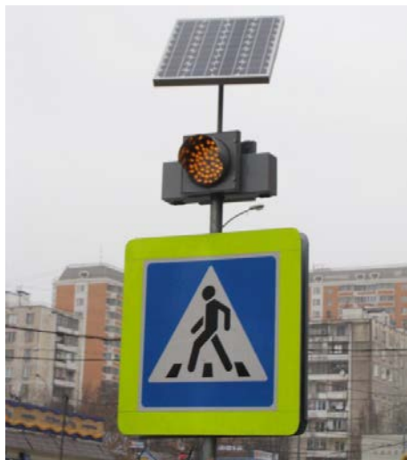
Рисунок 30 – Светодиодные светофоры с солнечными модулями и аккумуляторными батареями
